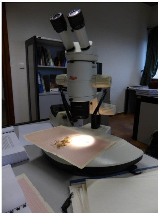
Εικόνα 3-12: Αναγνώριση δειγμάτων μακροφύτων στο στερεοσκόπιο
