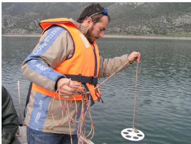
Εικόνα 1-16: Μέτρηση διαφάνειας με το δίσκο Secchi για τον υπολογισμό του εύρους της εύφωτης ζώνης
