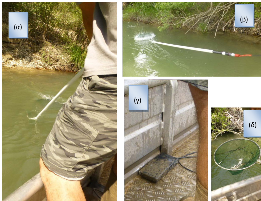
Εικόνα 1-11: Διαδικασία δειγματοληψίας με ηλεκτραλιεία συνεχούς ρεύματος από βάρκα. Το ηλεκτρόδιο ανόδου βυθίζεται στο νερό (α), ή εκτοξεύεται (β), ο χειριστής πατάει το πεντάλ διοχέτευσης του ρεύματος (γ) και συλλέγει τα ψάρια στην απόχη (δ). Ακολουθεί καταγραφή των ειδών και κλάσεων μήκους και αμέσως μετά τα δείγματα επιστρέφονται στο νερό.
