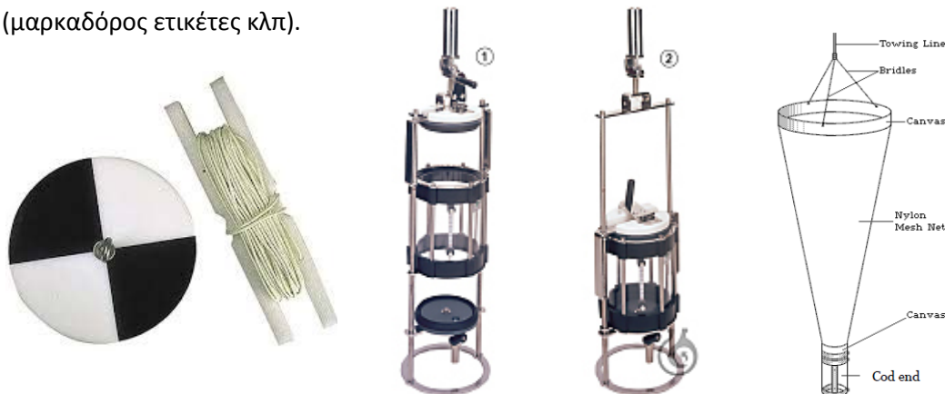
Εικόνα 1-15: Εξοπλισμός δειγματοληψίας φυτοπλαγκτού. Αριστερά: Δίσκος Secchi, Μέσον δειγματολήπτης διακριτού βάθους σε ανοιχτή και κλειστή θέση αντίστοιχα, Δεξιά: Συρόμενο πλαγκτονικό δίχτυ
